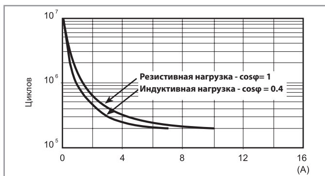
F 60 -Электрическая долговечность (AC) при ном. нагрузке
